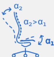
Синхромеханизм позволяет телу разгибаться: раздельное синхронное отклонение спинки и сиденья
